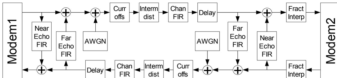
Симулятор моделирует следующие искажения сигнала:
